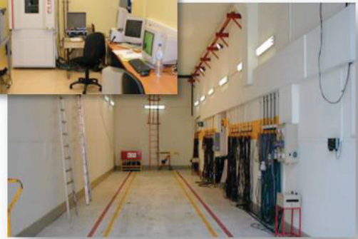
Tunnel CEMAFROID pour test et définition du coefficient d'isothermie "K" d'un véhicule type.
